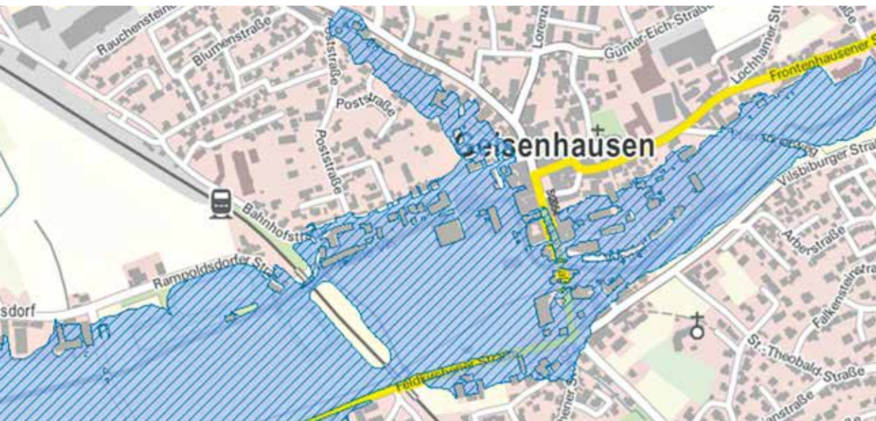
Überschwemmungsgefährdete Bereiche im Ortszentrum (Quelle: LfU)
